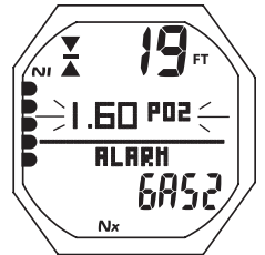
Fig. 96 - HIGH PO2 (100%) ALARM (during Deco)
